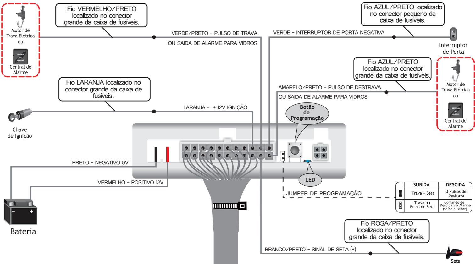
Realizar a passagem dos fios de dentro do veículo para dentro da porta do motorista e conectar os fios conforme o manual de instalação que acompanha o KIT de instalação individual.
