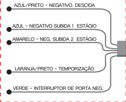
Realizar a passagem dos fios de dentro do veículo para dentro da porta dianteira direita e conectar os fios conforme o manual de instalação que acompanha o KIT de instalação individual.
