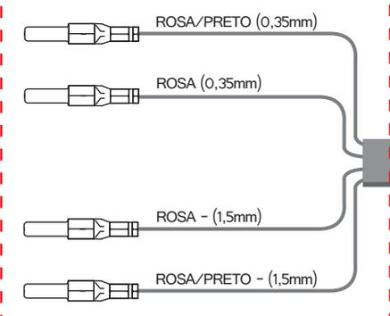
Conectar estes terminais, nas vias vagas do alojamento que se encontra no conector da coluna da porta traseira direita, conforme o manual de instalação que acompanha o KIT de instalação individual.
