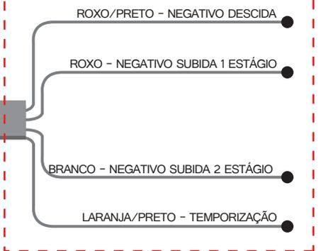
Conectar estes terminais, nas vias vagas do alojamento que se encontra no conector da coluna da porta traseira esquerda, conforme o manual de instalação que acompanha o KIT de instalação individual.
